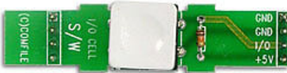
TACT SW Input I/O CELL
